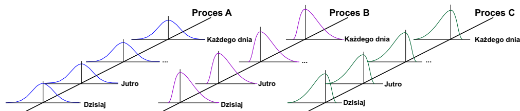
Rys. 3.34. Schemat procesu statystycznie stabilnego (kontrolowalnego) (opracowanie własne na podstawie [193])
