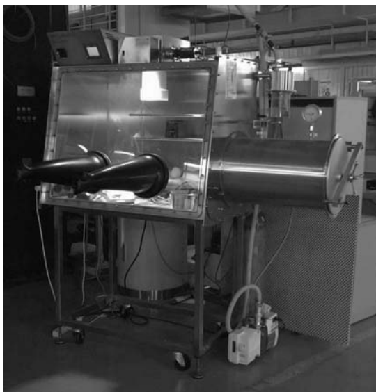
Rys. 15. Anaerobowa komora rękawicowa GP Campus-T2 w laboratorium CAMT
