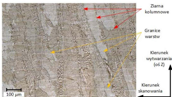
Rys. 78. Przykład kierunkowego krzepnięcia stopu Inconel 718 (CM)
