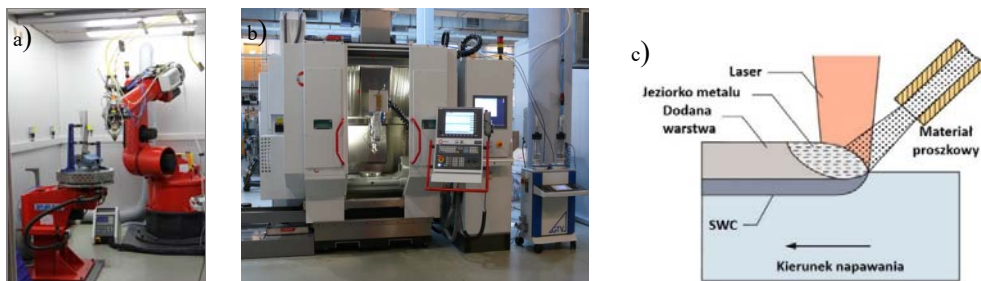
Rys. 8. Technologia napawania skoncentrowanym źródłem energii (DED): a) oparta na kinematyce robota, b) obrabiarki CNC, c) schemat działania technologii DED
