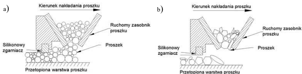
Rys. 32. Ruchomy zasobnik proszku wraz z zgarniaczem: a) nakładanie proszku o cząstkach kulistych, b) nakładanie proszku zawierającego cząstki o różnorodnym kształcie [87]
