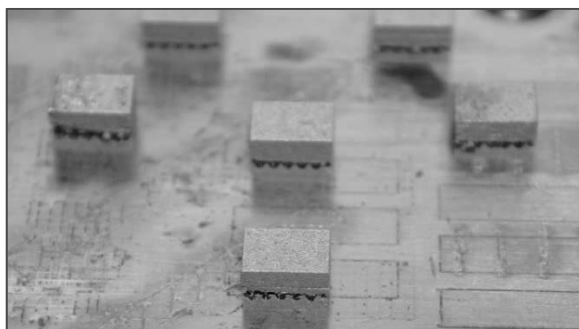
Rys. 68. Próbkki kontrolne ze stopu Ti6Al7Nb na platformie roboczej wytworzone technologią SLM w atmosferze ochronnej azotu
