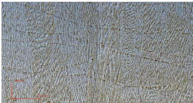
Rys. 114. Mikrostruktura stopu IN 718 po procesie SLM w stanie surowym. Ziarna kolumnowe, wewnątrz nich subziarna utworzone przez pakiety równoległych dendrytokomórek. Przekrój XZ. Trawienie gliceregia (CM)
