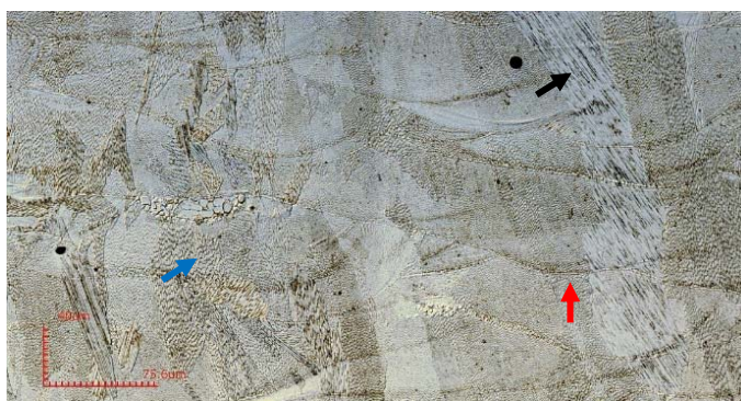
Rys. 109. Mikrostruktura stali 316L w stanie surowym (100 W/200 mm/s) na przekroju XZ : linia wtopienia pojedynczych ściegów (strzałka czerwona), por (strzałka czarna), wada budowania (strzałka niebieska) (CM)
