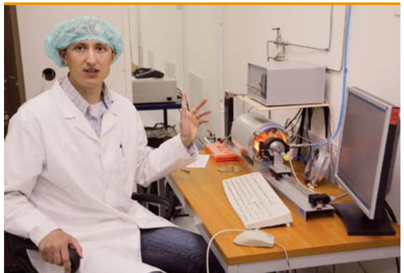
Mgr inż. Wojciech Macherzyński przy własnym, nagrodzonym przez NOT urządzeniu do wtapiania kontaktów metalicznych do struktur półprzewodnikowych
