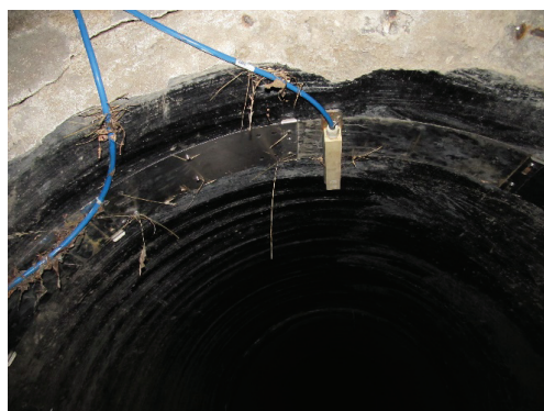
Rys. 3.7. Przepływomierz P1 typu Nivus PCM 4 zamontowany w studziencie nr 18 na kolektorze KD1 o średnicy 1,4 m; a) czujnik dolny, b) czujnik górny
