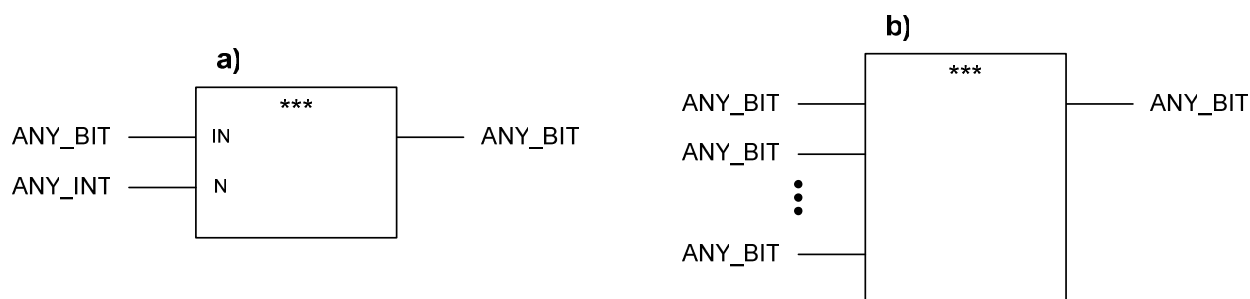
Rys.3.11. Ogólna postać funkcji na ciągach bitów: a) – funkcja przesuwania bitów, b) – funkcja logiczna.
