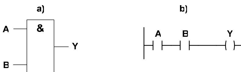
Rys.3.8. Programowa realizacja zadanej funkcji logicznej po zastosowaniu minimalizacji: a) – w języku FBD, b) – w języku LD.
