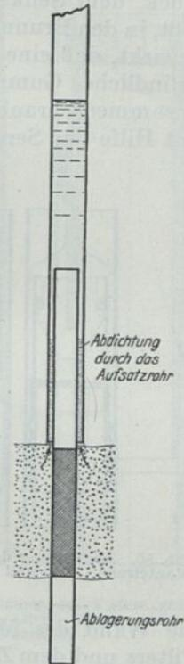
Abb. 49. Aufsatzrohr und Ablagerungsrohr.
