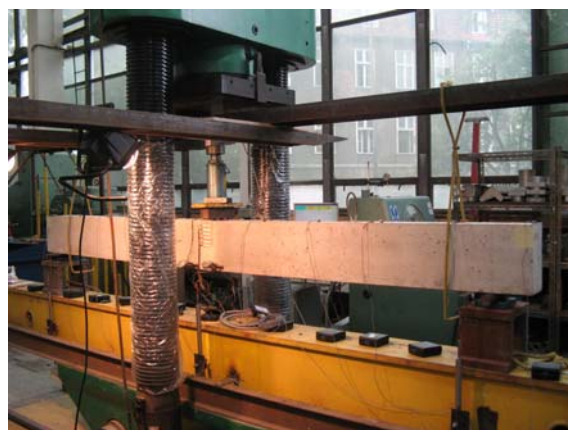
Fot. 4.22 – Belka przed inwentaryzacją rys
