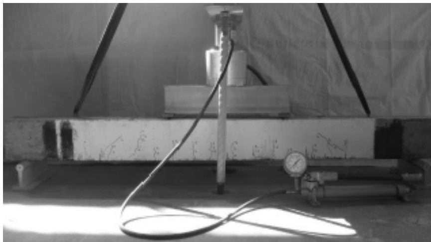
Fot. 2.1 – Stanowisko do obciążenia statycznego [14]
