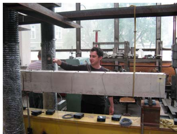
Fot. 4.20 – Wymuszanie drgań w operacyjnej analizie modalnej
