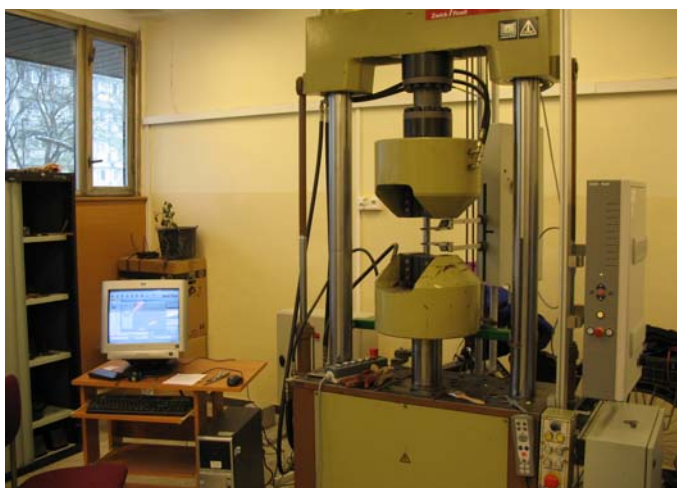
Fot. 4.14 – Stanowisko do badania stali zbrojeniowej
