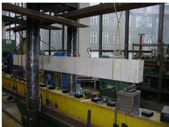
Fot. 4.19 – Belka podwieszona przed badaniem dynamicznym
