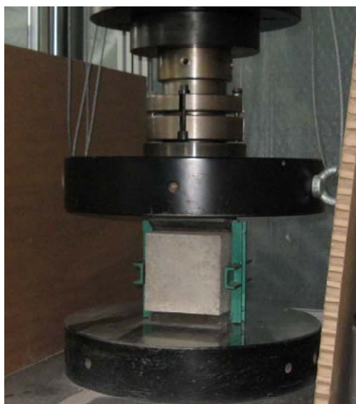
Fot. 4.17 – Próbkę do badania wytrzymałości na rozciąganie
