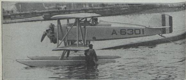
U. S. Navy T S 1b (1923) Kwa 1; E: J. R. Hunsacker b = 7,62 m; T = 21,00 m 2 ; G = 0,81 t; M: Wright 200 PS-HP-CV; Bst.: H, S, St.
