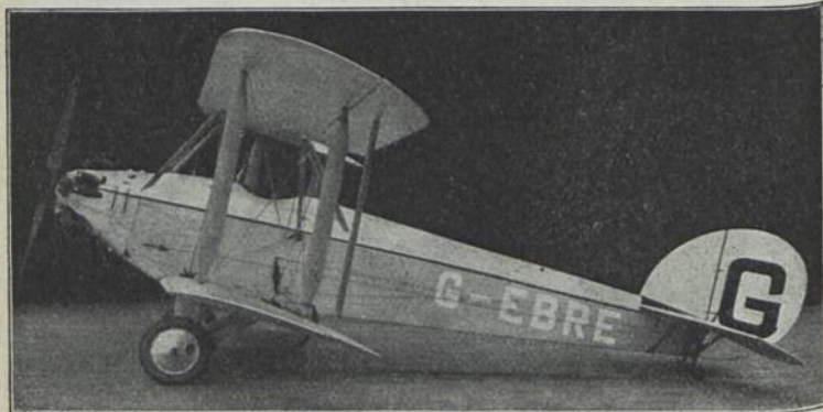
Blackburn „Bluebird II“ a (1926) Ü 2; E: F. A. Bumpus b = 8,53 m; l = 6,70 m; M: Siddeley 60 PS-HP-CV; Bst.: H, St.
