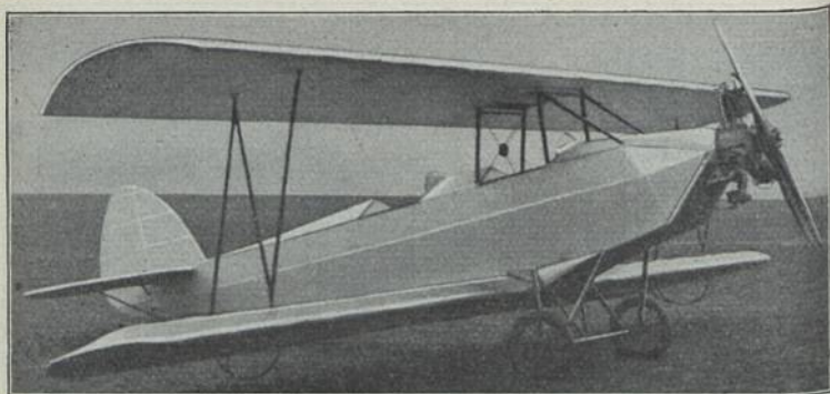
Raab-Katzenstein RK 9 „Grasmücke“ (1928) Sp 2; E: F. Hall b = 8,00 m; l = 6,55 m; T = 18,40 m 2 ; L = 0,23 t; N = 0,20 t; G = 0,43 t; V = 40—110 km/h; H = 3,0 km; M: Anzani 35 PS-HP-CV; Bst.: H, St, S.
