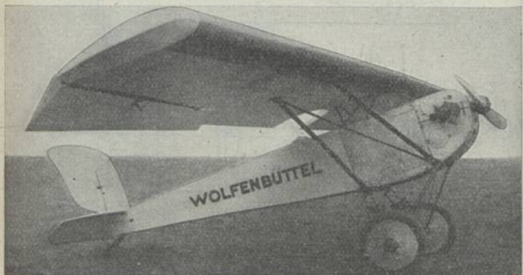
Braunschweig M B 5 „Wolfenbüttel“ (1925) Sp 1; E: A. Priesterjahn b = 8,60 m; l = 5,12 m; T = 11,50 m 2 ; L = 0,24 t; N = 0,11 t; G = 0,35 t; V = 61—112 km/h; H = 2,5 km; M: Haacke 30 PS-HP-CV; Bst.: H, S, St.
