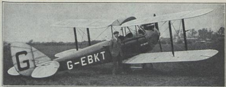
de Havilland D. H. 60a „Moth“ (1925) Sp 2; E: G. de Havilland b = 8,84 m; l = 7,17 m; T = 21,00 m 2 ; L = 0,34 t; N = 0,22 t; G = 0,65 t; V = 61–145 km/h; M: A. D. C. 60 PS-HP-CV; Bst.: H, St.
