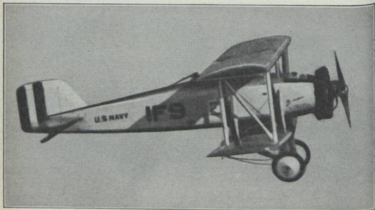
U. S. Navy T S 1a (1923) Ka 2; E: J. R. Hunsacker b = 7,62 m; l = 7,50 m; T = 21,00 m 2 ; G = 0,92 t; V = 210 km/h; M: Wright 200 PS-HP-CV; Bst.: H, S, St.
