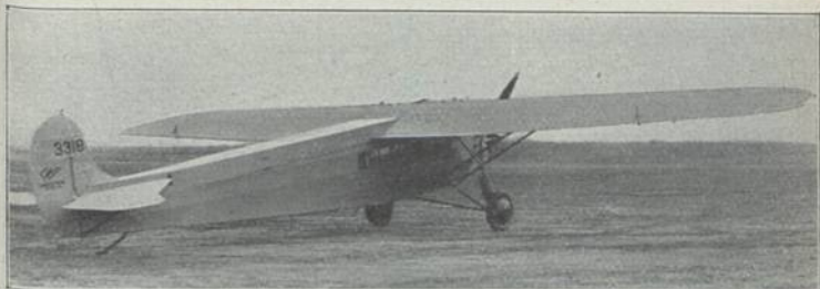
Fokker „Super-Universal“ (1928) V; E: A. A. Gassner M: Pratt 425 PS-HP-CV; Bst.: H, S, St.
