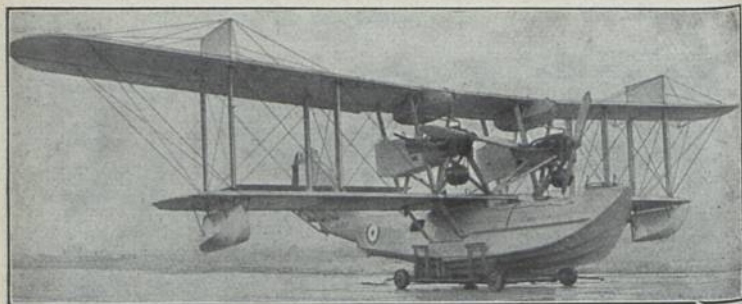
E. E. C. „Kingston II“ (1926) Ksb 3; E: W. O. Manning b = 25,90 m; l = 16,15 m; M: 2 × Napier 450 PS-HP-CV = 900 PS-HP-CV; Bst.: H, St, S, D,
