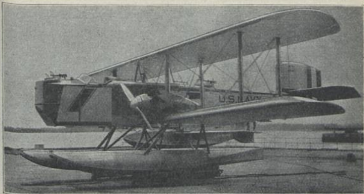
U. S. Navy T N-1 (1926) Ksb 5; E: G. C. Westervelt M: 2 \times Wright 525 PS-HP-CV = 1050 PS-HP-CV; Bst.: H. S. St.
