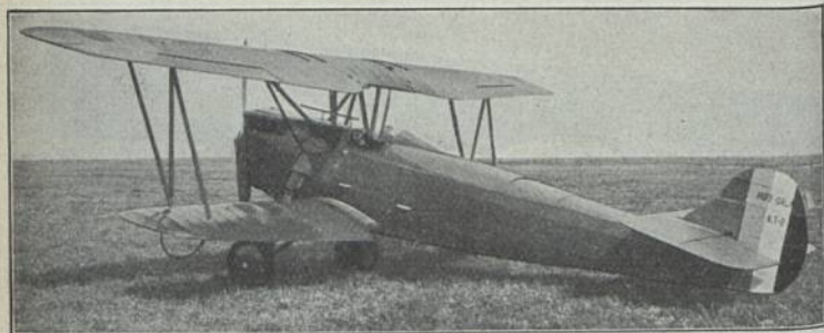
Keystone A T 2 a „Panther“ (1926) K1 1; E: C. T. Porter b = 8,83 m; l = 7,31 m; M: Wright 180 PS-HP-CV; Bst.: H, S, St.
