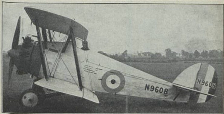
Parnall „Plover I“ (1924) KJ 1; E: H. Bolas M: Bristol 420 PS-HP-CV; Bst.: H, St.
