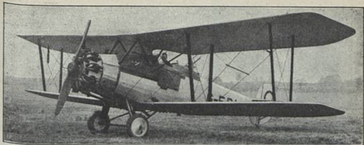
Bristol „Boarhound“ (1926) Ka 2; E: F. Barnwell M: Bristol 450 PS-HP-CV; Bst.: S, D, St.
