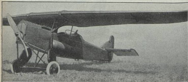
Junkers H 21 (1924) Ka 2; E: Junkers M: B. M. W. 185 PS-HP-CV; Bst.: D.
