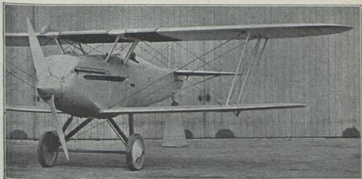
Fairey „Firefly“ (1926) KJ 1; E: C. R. Fairey M: Fairey 430 PS-HP-CV; Bst.: H. S. St.
