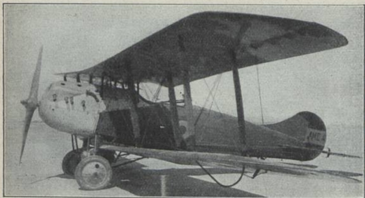
A M E IV (1926) Ka 2; E: M. Bada M: Fiat 450 PS-HP-CV; Bst.: H, S, St.
