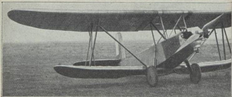
Meteor L 1 (1927) Sp 2; E: W. Mertens; W. Meyer-Kassel b = 8,40 m; l = 6,30 m; T = 18,00 m 2 ; L = 0,20 t; N = 0,18 t; G = 0,38 t; V = 48—120 km/h; M: A. B. C. 36 PS-HP-CV; Bst.: H. St. Meteor-Flugzeugbau, Hannover
