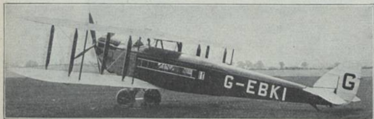
de Havilland D. H. 54 „Highclere“ (1925) V 14; E: G. de Havilland b = 20,75 m; l = 15,55 m; T = 97,00 m 2 ; V = 88—117 km/h; H = 4,5 km; M: Rolls Royce 650 PS-HP-CV; Bst.: H, St.
