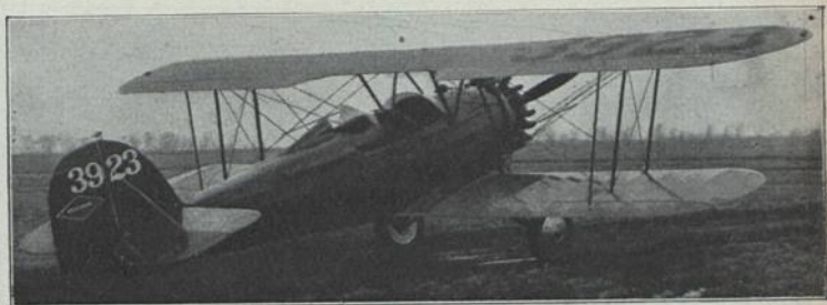
Laird „Commercial III“ (1926) Sp 2; E: E. M. Laird b = 10,10 m; l = 7,20 m; T = 27,90 m 2 ; L = 0,70 t; N = 0,36 t; G = 1,06 t; V = 65–209 km/h; M: Wright 200 PS-HP-CV; Bst.: H. S. St.
