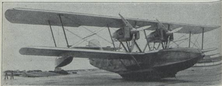
U. S. Navy P N 10 (1926) Ksb 5; E: G. C. Westervelt b = 21,94 m; l = 14,93 m; M: 2 × Packard 500 PS-HP-CV = 1000 PS-HP-CV; Bst.: H, S, St.
