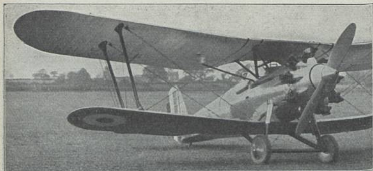
Bristol „Bulldog“ (1927) Kl 1; E: F. Barnwell M: Bristol 450 PS-HP-CV; Bst.: H. St. S. D.
