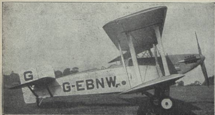
Avro „Buffalo“ (1928) Ka 2; E: R. Chadwick M: Napier 450 PS-HP-CV; Bst.: H, St.
