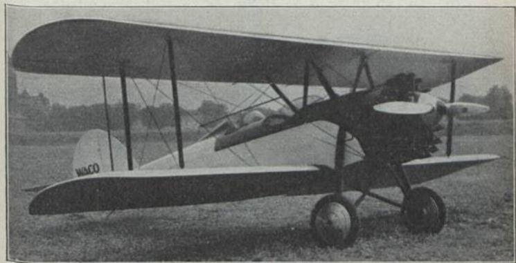
Advance „Waco 10 W“ (1927) Sp 3 M: Wright 200 PS-HP-CV; Bst.: H, St.
