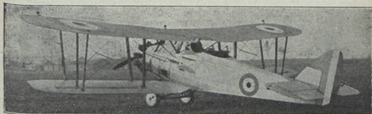
Bristol „Beaver“ (1927) Ka 2; E: F. Barnwell M: Bristol 450 PS-HP-CV; Bst.: H, S, St.
