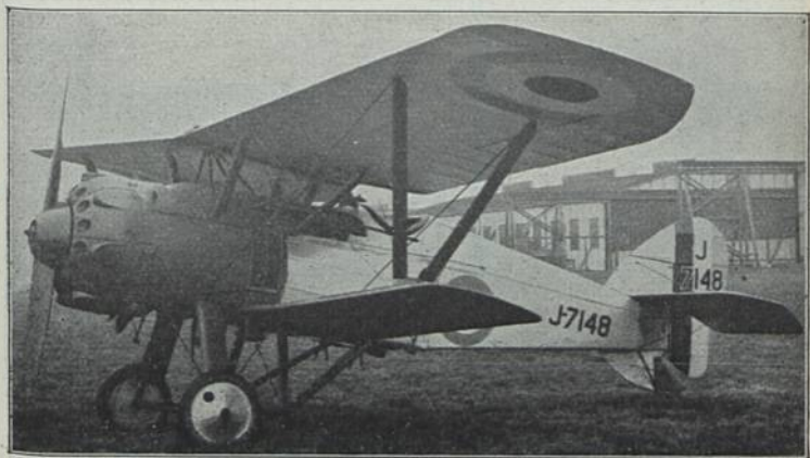
Armstrong Whitworth „Siskin III A“ (1928) KJ 1; E: M. Green b = 9,80 \text{ m} ; l = 7,72 \text{ m} ; T = 27,22 \text{ m}^2 ; L = 0,95 \text{ t} ; N = 0,41 \text{ t} ; G = 1,36 \text{ t} ; V = 85\text{--}247 \text{ km/h} ; H = 8,2 \text{ km} ; St = 6,0 \text{ km/17'} ; M: Siddeley 385 PS-HP-CV; Bst.: S. St.
