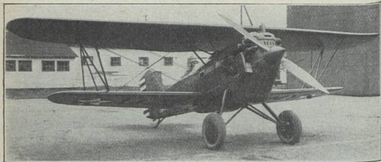
Curtiss P-5 „Hawk“ (1928) Kj 1; E: T. P. Wright M: Curtiss 400 PS-HP-CV; Bst.: H. S. St.
