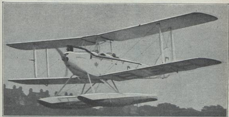
de Havilland D. H. 60b „Moth“ (1927) Spw 2; E: G. de Havilland b = 8,84 m; l = 7,17 m; T = 21,00 m 2 ; M: A. D. C. 60 PS-HP-CV; Bst.: H, St.
