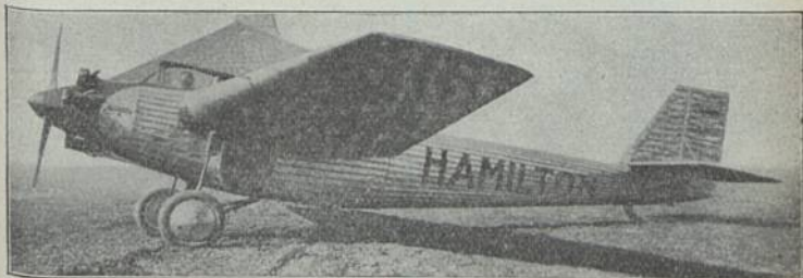
Hamilton „Cabin“ (1928) V 5; E: F. Hamilton b = 14,63 m; l = 9,44 m; L = 0,85 t; M: Wright 200 PS-HP-CV; Bst.: D.
