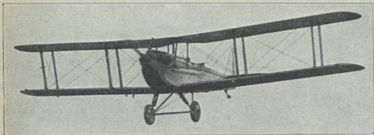
de Havilland D. H. 65 „Hound“ (1928) Ka 2; E: G. de Havilland M: Napier 450 PS-HP-CV; Bst.: H. S. St.
