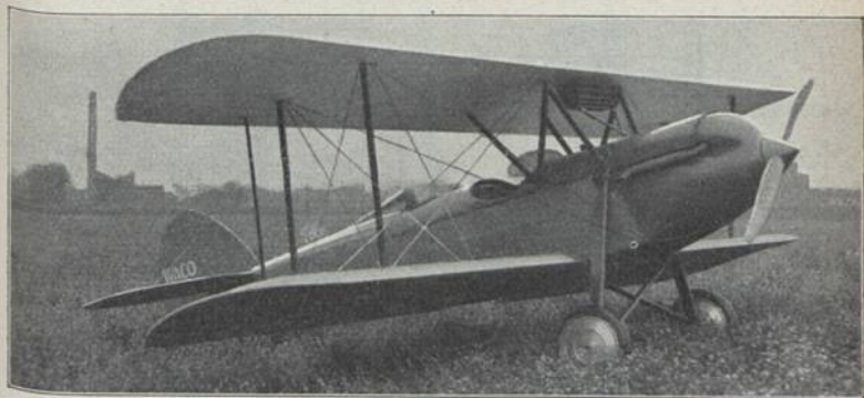
Advance „Waco 10 C“ (1928) Sp 2 M: Curtiss 90 PS-HP-CV; Bst.: H, St.
