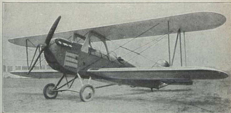
Gl. Martin M 70 (1924) Pn 1; E: G. Madelung b = 11,58 m; l = 8,49 m; T = 34,20 m 2 ; L = 0,97 t; N = 0,50 t; G = 1,47 t; V = 73–180 km/h; H = 5,1 km; M: Wright 200 PS-HP-CV; Bst.: H, S, St.
