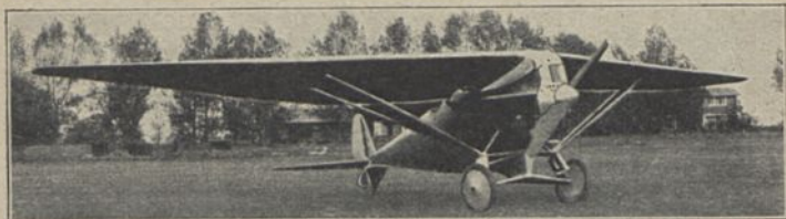
Dobkevitch D 2 (1924) Ka 2; E: G. Dobkevitch b = 14,00 m; l = 6,12 m; L = 0,84 t; V = 248 km/h; H = 9,0 km; M: Benz 200 PS; MG: 2; Bst.: Holz, Stoff
