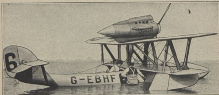
Blackburn „Pellet“ (1923) Sps 1; E: J. D. Rennie M: Napier 450 PS; Bst.: Holz, Stoff
