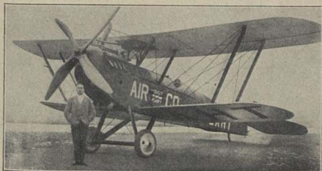
de Havilland D H 9 R (1922) Sp 1; E: G. de Havilland Bst.: Holz, Stoff
