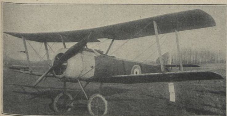
Sopwith „Camel“ (1918) Kj 1; E: T. O. M. Sopwith b = 8,37 m; L = 0,23 t; N = 0,7C t; G = 0,93 t; V = 192 km/h; M: Clerget 130 PS; MG: 2; Bst.: Holz, Stoff
