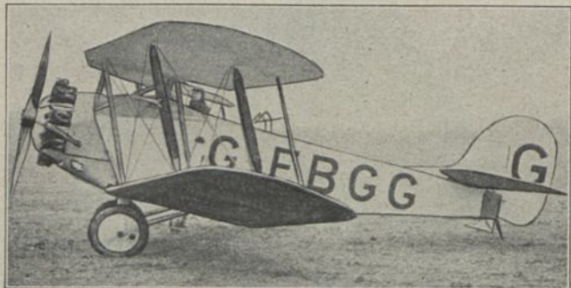
Bristol „Bloodhound“ (1924) Ka 2; E: F. Barnwell M: Bristol 400 PS; MG: 3; Bst.: Dural, Stahl, Stoff
