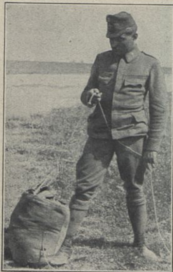
Heinecke-Sitzkissen (1916) verpackt Seilverbindung zwischen Schirm u. Luft- fahrzeug. Schirmhülle in Sackform.
