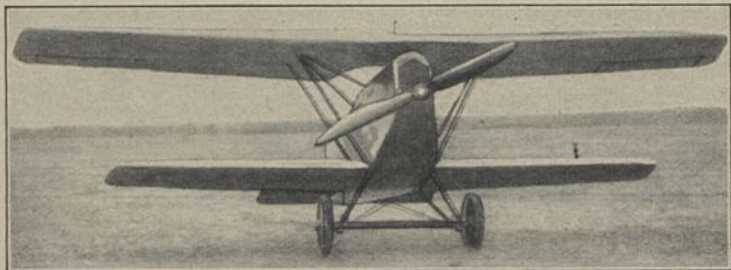
Gabriel (1924) Sp 2; E: W. Gabriel T = 16,50 qm; L = 0,48 t; N = 0,24 t; G = 0,72 t; V = 175 km/h; M: Mercedes 75/85 PS; Bst.: Holz, Stoff
