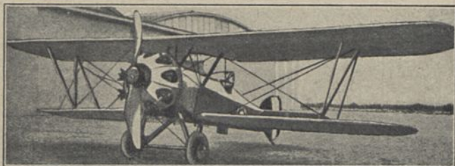
Bristol „Badger“ (1921) Ka 2; E: C. H. Reid; b = 11,20 \text{ m} ; l = 7,20 \text{ m} ; T = 34,00 \text{ qm} ; L = 0,93 \text{ t} ; N = 0,42 \text{ t} ; G = 1,35 \text{ t} ; V = 227 \text{ km/h} ; H = 7,3 \text{ km} ; M : Bristol 450 PS; MG : 2; Bst. : Holz, Stoff
