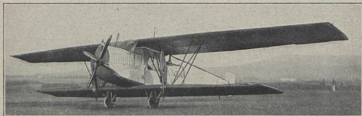
Avis BGV-I (1924) V 8; E: J. v. Berg b = 19,60 \text{ m} ; l = 13,20 \text{ m} ; T = 65,00 \text{ qm} ; L = 2,18 \text{ t} ; N = 0,92 \text{ t} ; G = 3,10 \text{ t} ; M = 2 \times 100 \text{ PS} , 1 \times 250 \text{ PS} = 450 \text{ PS} ; Bst.: Holz, Stahl, Stoff
