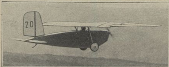
Sperber „Knorcke“ (1924) Sp 1 b = 12,00 \text{ m} ; l = 5,00 \text{ m} ; T = 14,40 \text{ qm} ; M: \text{Prüssing } 10 \text{ PS} ; \text{Bst.: Holz, Stoff} Sperber-Berliner Segelflugverein, Berlin
