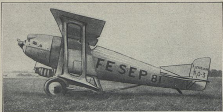
Levasseur T O 3 (1922) Sp 1; E: P. Levasseur M: Hispano 180 PS; Bst.: Holz, Stoff
