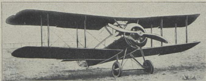
Sopwith „Snipe“ (1919) K j 1; E: M. Sopwith b = 9,44 m; l = 5,84 m; L = 0,59 t; N = 0,32 t; G = 0 91; V = 194 km/h H = 5,9 km; M: B. R. 2 230 PS; Bst.: Holz, Stoff
