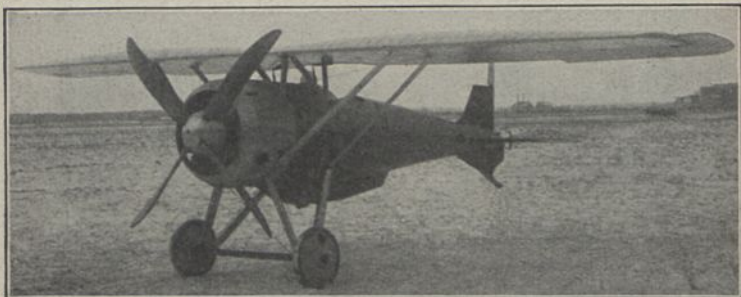
Siemens S. S. W. D VI (1918) K1 1; E: H. Wolff b = 9,30 m; l = 6,40 m; L = 0,54 t; N = 0,23 t; G = 0,77 t; V = 220 km/h; M: Siemens 160 PS; MG: 2; Bst.: Holz, Stoff
