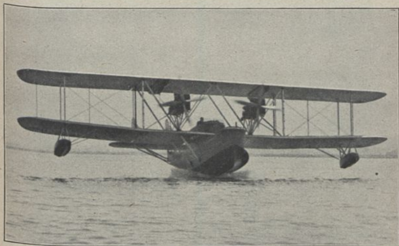
Supermarine „Swan“ (1924) Ksb 4; E: R. J. Mitchell b = 21,00 \text{ m} ; l = 17,10 \text{ m} ; L = 3,55 \text{ t} ; N = 1,87 \text{ t} ; G = 5,42 \text{ t} ; V = 150 \text{ km/h} ; M: 2x Rolls Royce 360 PS = 720 PS; Bst.: Holz, Stoff
