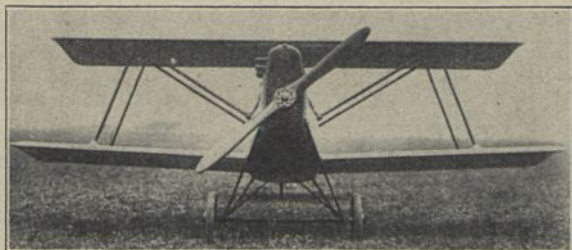
Ansaldo A 200 (1923) Kj 1; E: Verduzzio M: S. P. A. 200 PS; MG: 2 Bst.: Holz, Stoff
