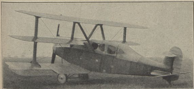
Hawa F 10 (1919) V 4 E: R. Dörner b = 11,50 m; l = 8,1 m; V = 175 km/h; M: Benz 200 PS; Bst.: Holz, Stoff Hannoversche Waggonfabrik, Hannover-Linden
