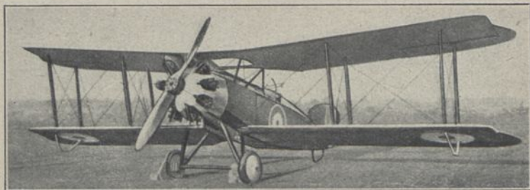
Westland „Weasel“ (1923) Ka 2; E: R. A. Bruce M: Bristol 400 PS; MG: 3; Bst.: Holz, Stoff
