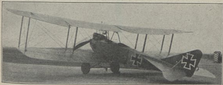
Albatros B II (1915) Ka 2 u. U 2 G = 1,05 t; M: Mercedes 100 PS; MG: 0; Bst.: Holz, Stoff
