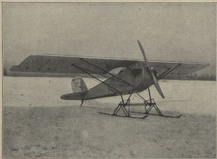
Mark R IIIa/21 (1922) Sp 1; E: W. Rieseler b = 7,30 \text{ m} ; l = 5,00 \text{ m} ; T = 10,00 \text{ qm} ; L = 0,16 \text{ t} ; N = 0,14 \text{ t} ; G = 0,30 \text{ t} ; V = 120 \text{ km/h} ; H = 3,5 \text{ km} ; M : Haacke 35 PS; Bst. : Holz, Stahl, Stoff Stahlwerk Mark, Breslau
