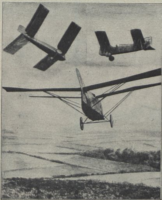
Peyret (1922); E: L. Peyret b = 6,60 \text{ m} ; t = 1,10 \text{ m} ; T = 14,20 \text{ qm} ; l = 5,30 \text{ m} ; L = 67,5 \text{ kg} ; G = 138,0 \text{ kg} ; G/T = 9,7 \text{ kg/qm} ; Bst.: Holz, Stoff L. Peyret, Courtevoie
