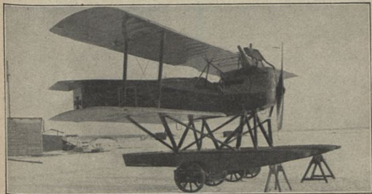
Hansa-Brandenburg W 32 (1918) Kwa 2; E: E. Heinkel. b = 11,20 m; l = 9,50 m; T = 35,00 qm; L = 1,06 t; N = 0,48 t; G = 1,54 t; M: Mercedes 170 PS; MG 2. Bst.: Holz, Stoff
