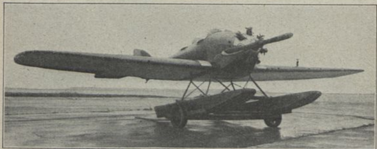
Heinkel HE 5 (1923) Üw 3; E: E. Heinkel b = 10,40 m; l = 7,80 ; T = 18,00 qm; L = 0,52 t; N = 0,32 t; G = 0,84 t; V = 140 km/h; H = 4,0 km; M : Siemens 110 PS E. Heinkel, Flugzeugwerke, Warnemünde
