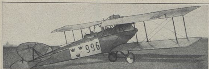
Mälmslatt (1922) Ka 2, M: Maybach 260 PS; MG: 2; Bst.: Holz, Stoff
