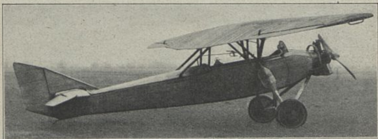
Junkers T 19 (1923) Ü 2; E: Junkers b = 13,00 m; l = 7,50 m; N = 0,25 t; V = 115 km/h; M: Siemens 50 PS Bst.: Dural
