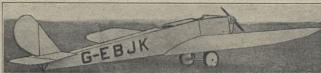
Bristol „Brownie“ (1924) Sp 2; E: F. Barnwell b = 10,95 \text{ m} ; l = 7,94 \text{ m} ; T = 18,90 \text{ qm} ; L = 0,22 \text{ t} ; N = 0,17 \text{ t} ; G = 0,39 \text{ t} ; V = 110 \text{ km/h} ; M : Bristol 32 PS; Bst. : Holz, Stahl, Stoff
