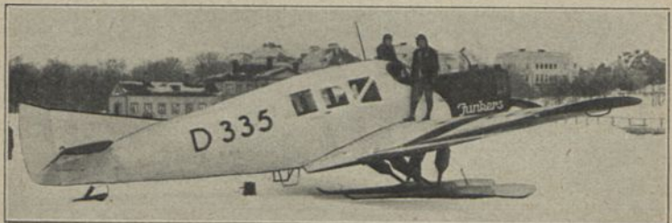
Junkers F 13 S (1920) V 6; E: Junkers Bst.: Dural
