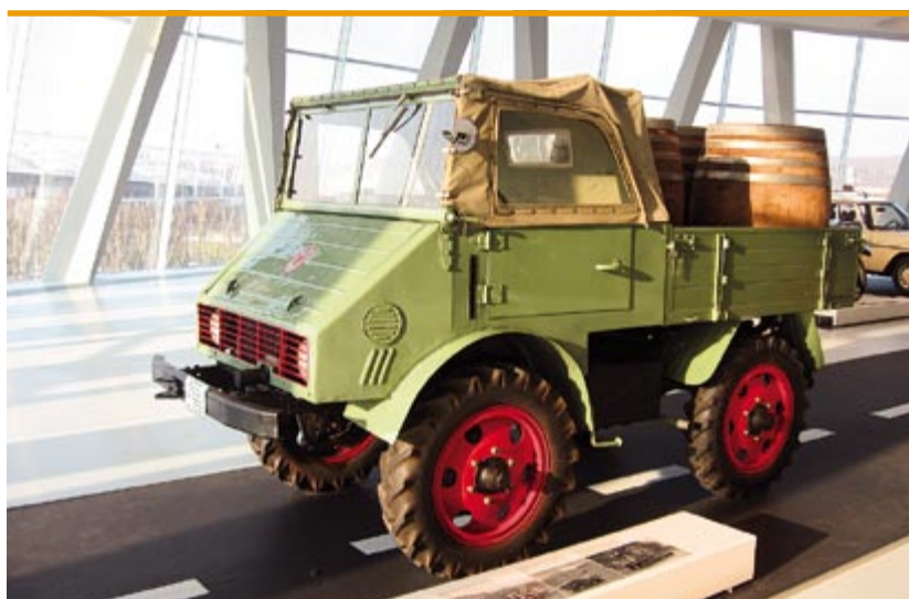
Charakterystyczna sylwetka uniwersalnego czterocylindrowego pojazdu Unimog 25 PS przeznaczonego głównie do wspomagania pracy rolników
