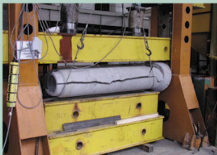
Stanowisko do badania kształtek betonowych
