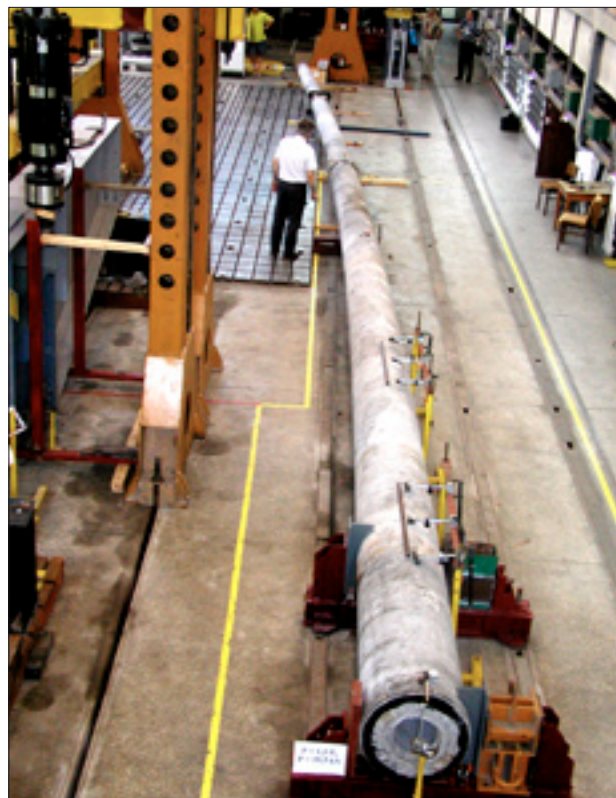
Na stanowisku pomiarowym żelbetowa żerdź energetyczna
