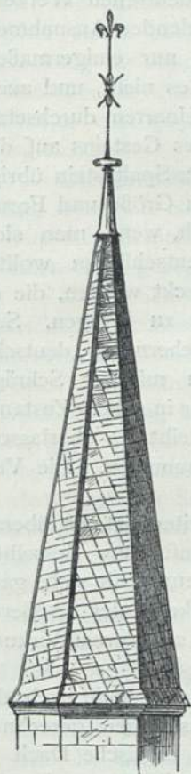
Abb. 45. Turmpyramide mit altdeutscher Schieferdeckung.
