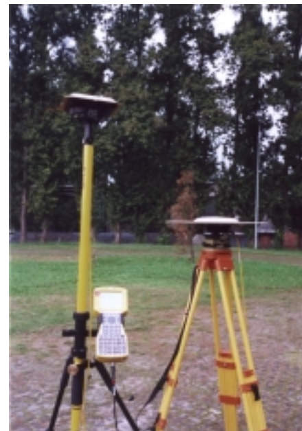
Anteny stacji bazowej i odbiornika ruchomego z kontrolerem
