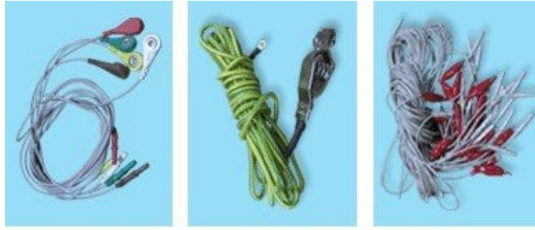
Rys. 3.2.1 Okablowanie do urządzenia KT-88 do pomiaru sygnału EEG wykorzystywane w Laboratorium pomiarów biomedycznych Politechniki Opolskiej. [Źródło: opracowanie własne]
