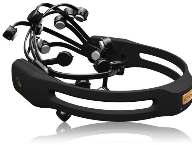
Rys. 3.3. Urządzenie Emotiv EPOC Neuroheadset do akwizycji i sterowania aplikacjami na stacji roboczej za pomocą sygnału EEG wykorzystywane w Laboratorium pomiarów biomedycznych Politechniki Opolskiej. [Źródło: opracowanie własne]
