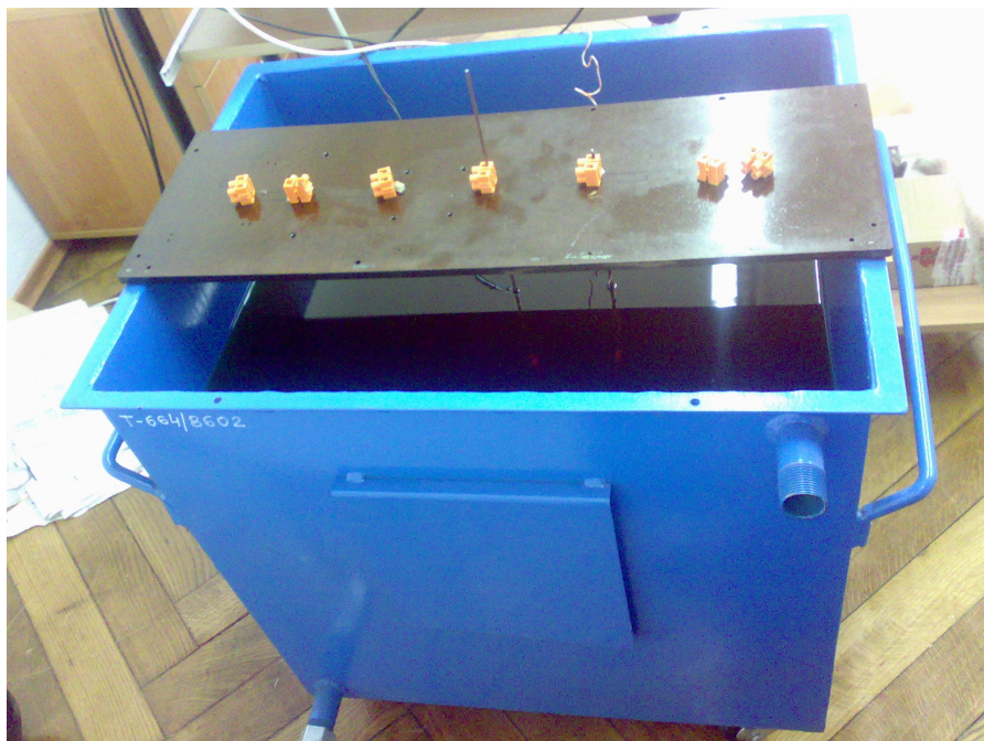
Rysunek 7.5: Widok modelu kadzi i płyty bakelitowej z zamocowanymi elementami umożliwiającymi montaż przetworników piezoelektrycznych, które wykorzystano w badaniach eksperymentalnych
