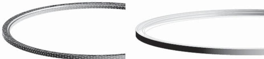
Rys. 8.4. Model pierścienia tłokowego podzielony na elementy skończone z powłoką z azotku tytanu zamodelowaną w postaci elementów płaszczyznowych
