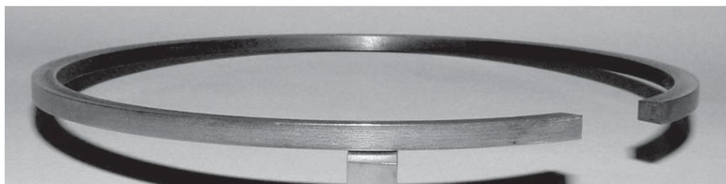
Rys. 8.16. Fotografia pierwszego pierścienia uszczelniającego z powłoką z TiN pierwszego gniazda silnika kierowanego do badań wstępnych
