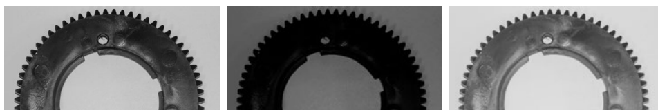
Rysunek 4.6: Obraz oryginalny i po transformacji gamma dla \gamma = 0.3 i 1.7
