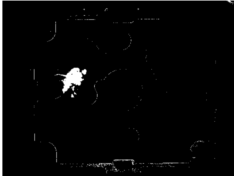
Rysunek 8.16: Wykrywanie wycieku – segmentacja
