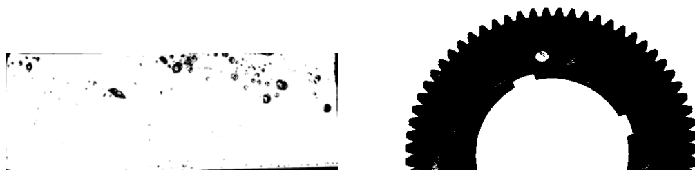
Rysunek 7.15: Wynik progowania metodą Metoda Kittler'a-Illingworth'a
