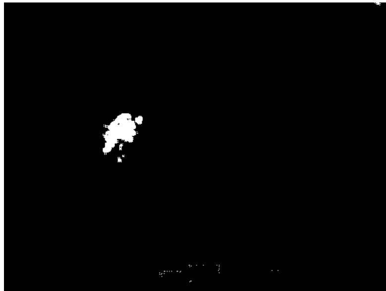
Rysunek 8.17: Wykrywanie wycieku – poprawa rezultatów segmentacji
