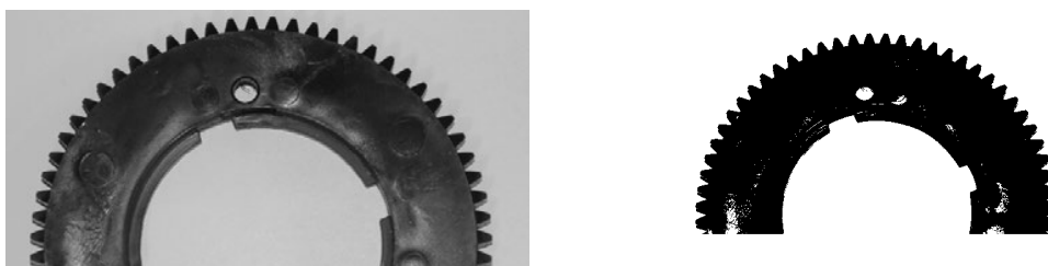
Rysunek 7.6: Progowanie metodą Otsu i 2-średnich; T = 123
