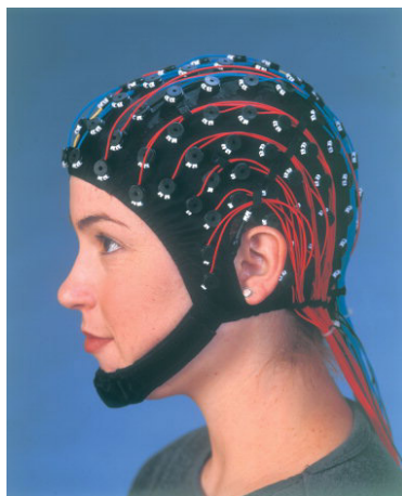
RYSUNEK 3.25: Czepek z elektrodami EEG do pomiarów sygnałów ośrodkowego układu nerwowego. [(Weir, 2004)]
