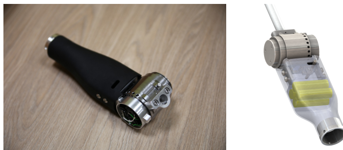
RYSUNEK 6.16: Model oraz prototyp modułu stawu łokciowego wykorzystującego walcowe przekładnie zębate
