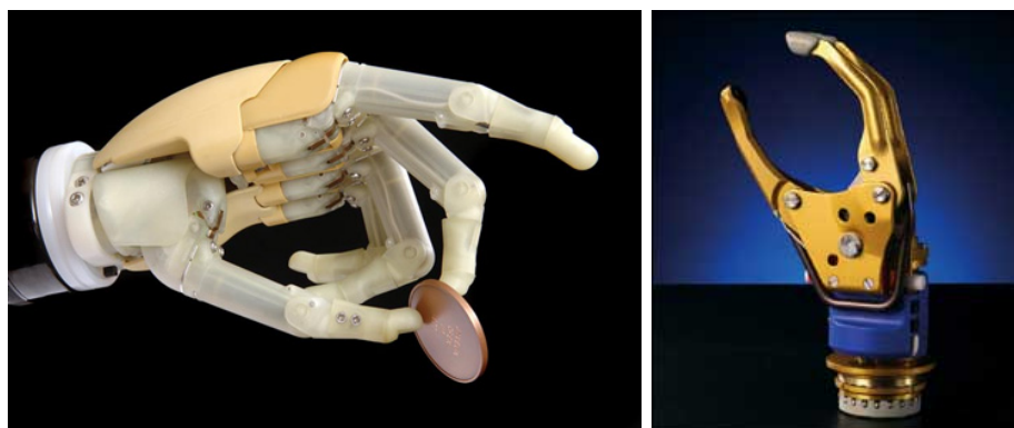
RYSUNEK 3.2: Przykładowe rozwiązanie protezy ręki sterowanych mechanicznie [( b.d.[c])].
