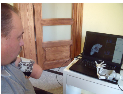
RYSUNEK 7.3: Widok komputerowego systemu treningowego opracowanego do nauki oraz doboru parametrów pomiarowych elektrody EMG
