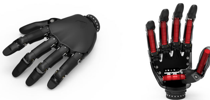
RYSUNEK 3.20: Wygląd i struktura napędowa protezy Vincent Evolution [( b.d.[o])]
