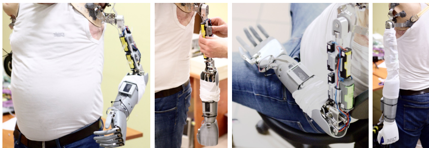
RYSUNEK 7.16: Prototypy protezy kończyny górnej SS1SU2SJ3SD5SM2/s2p5u1z1b3a1m2 pacjenta zamontowane na pacjencie referencyjnym z obustronną amputacją
