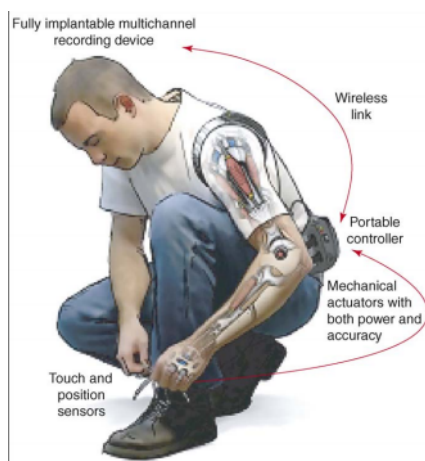
RYSUNEK 3.28: Implantowalny system sterowania protezą.[(Horch, b.d.)]
