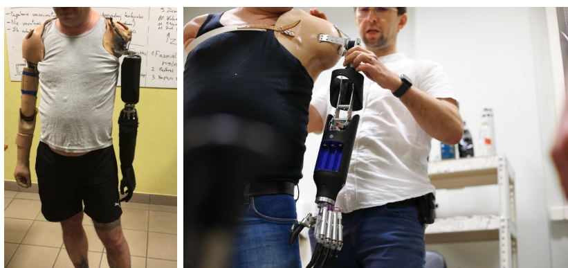
RYSUNEK 7.17: Prototypy protezy kończyny górnej SS1SU2SJ3SD5SM2/s2p6u2z1b3a1m2 pacjenta zamontowane na pacjencie referencyjnym z obustronną amputacją
