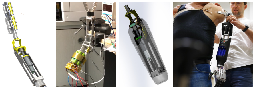
RYSUNEK 6.17: Modele oraz prototypy rozwiązań modułu łokcia podczas testów (od lewej: model oparty na przekładni trapezowej, testy przekładni trapezowej, model oparty na przekładni kulowej, testy z udziałem użytkownika prototypu z przekładnią kulową)
