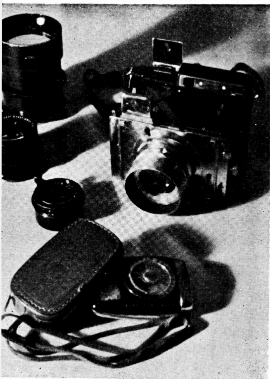
Zdjęcie wykonane kamerą otworkową. Otwór 0,5 mm. Wyciąg kamery 25 cm, negatyw 9 × 12 cm. Oświetlenie 1 Nitraphot z odległości 1,5 m. Czas naświetlania 20 minut.
