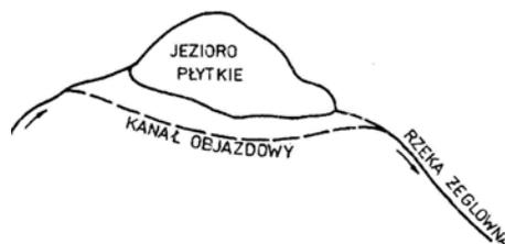
Rys. 7.15. Przykład kanału objazdowego
