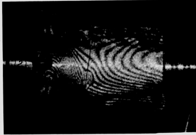
Rys.64 Hologram promieniowych przemieszczeń zewnętrznej powierzchni nakrętki przekładni VNB 32x6 / P_0=10kN /.
