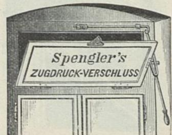
lich, ehe man zum Schließen greift, die Schnur ganz frei zu lassen, damit der Verschlusshebel vorwärts fallen und der Selbststeller *f* als Widersteller desselben hervortreten kann. Das Anziehen der Schnur bringt den Ansatz *i* gegen die
