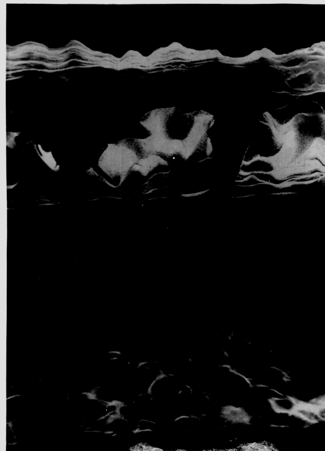
Rys.40. Zdjęcie mikroskopowe przekroju poprzecznego membrany o grubości 45 \mu\text{m} formowanej z roztworu o temperaturze 318 K przez odparowanie rozpuszczalnika w ciągu 60 s. Powiększenie 2000 X.
