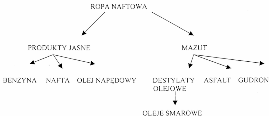
Schemat 1. Destylacyjna przeróbka ropy naftowej
