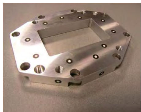
Rys. 7.1. Badany obiekt ze stopu aluminium (widoczne markery stosowane w pomiarach optycznych)
