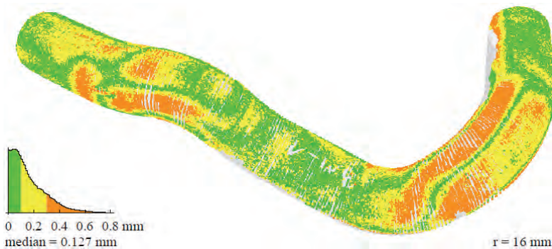
Rys. 6.31. Identyfikacja obiektu typu „rura” jako ciągłego i gładkiego połączenia walców i torusów [16]
