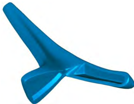
Rys. 7.15. Model powierzchniowy w postaci siatki trójkątów
