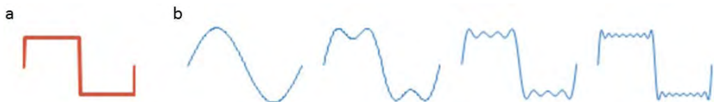
Rys. 4.1. Wpływ częstotliwości próbkowania na jakość rekonstrukcji sygnału: (a) – oryginalny sygnał prostokątny, (b) – sygnał odtworzony kolejno z: dwóch, czterech, ośmiu i szesnastu równoodległych próbek (oprac. własne)
