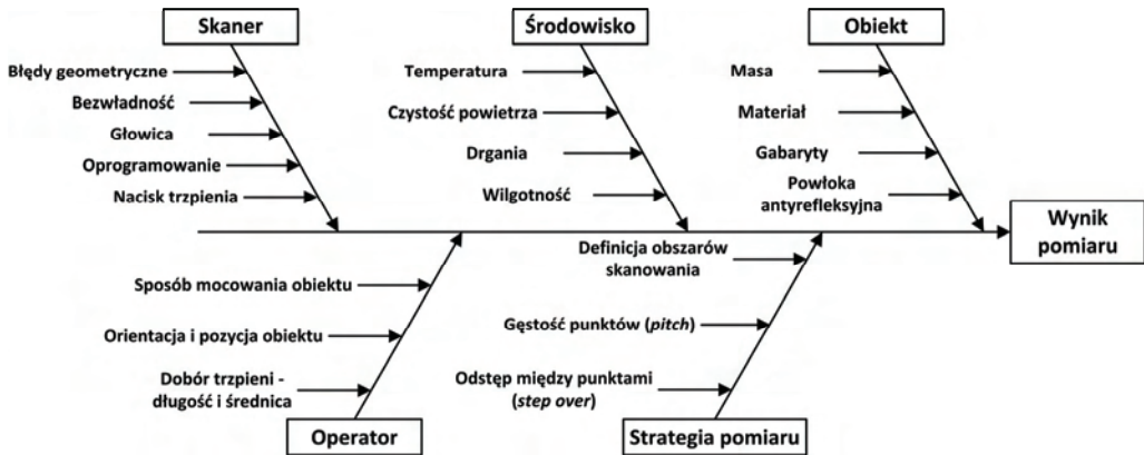
Rys. 5.6. Źródła niepewności pomiaru skanerem stykowym [22]
