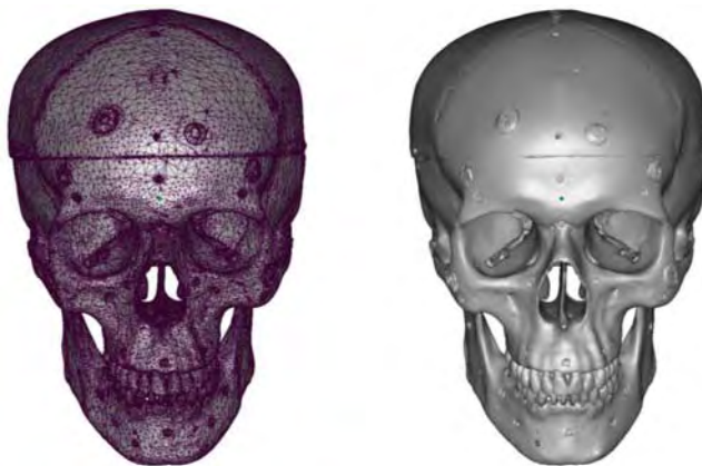
Rys. 7.23. Wynikowy model powierzchniowy czaszki (w widoku z trójkątami i widoku cieniowanym)
