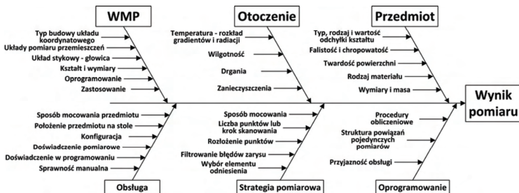
Rys. 5.4. Źródła błędów pomiaru na WMP [211]
