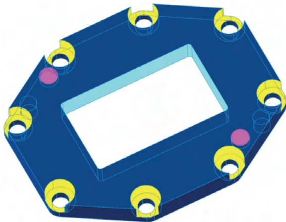
Rys. 6.28. Przykład dopasowania prymitywów geometrycznych do siatki trójkątów
