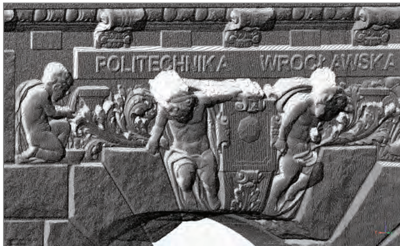
Rys. 6.6. Chmura punktów po digitalizacji obiektu 3D (obiekt: płaskorzeźba na portalu jednego z budynków Politechniki Wrocławskiej, urządzenie pomiarowe: skaner laserowy punktowy średniego zasięgu)
