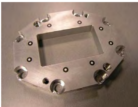
Rys. 7.1. Badany obiekt ze stopu aluminium (widoczne markery stosowane w pomiarach optycznych)
