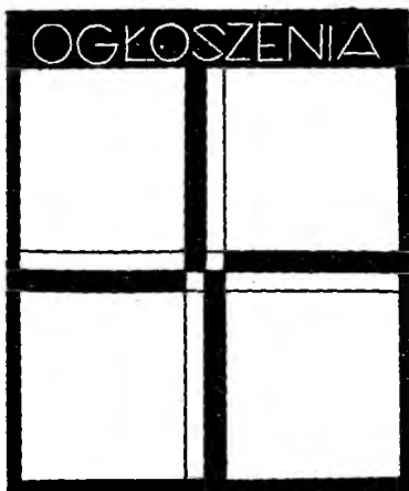
Rys. 12. Tablica ogłoszeń. Tablica drewniana 100 × 80 cm. Listwy z boku trochę wystające, pomalowane na jeden kolor na wszystkich tablicach. Napis — na czerwonym tle żółte litery, pasy dzielące tablice na pola żółte i czerwone. Pola koloru drzewa politurowane.
