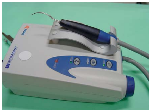
Ryc. 1. DetecTar – urządzenie do wykrywania kamienia poddziąsłowego
