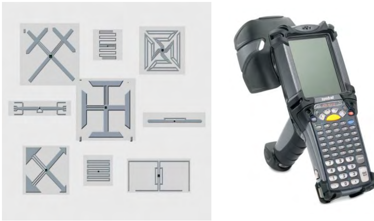
Rys. 3. Przykłady różnych rodzajów metek RFID oraz przenośny czytnik RFID Źródło: (Muszyński, Borck 2006).
