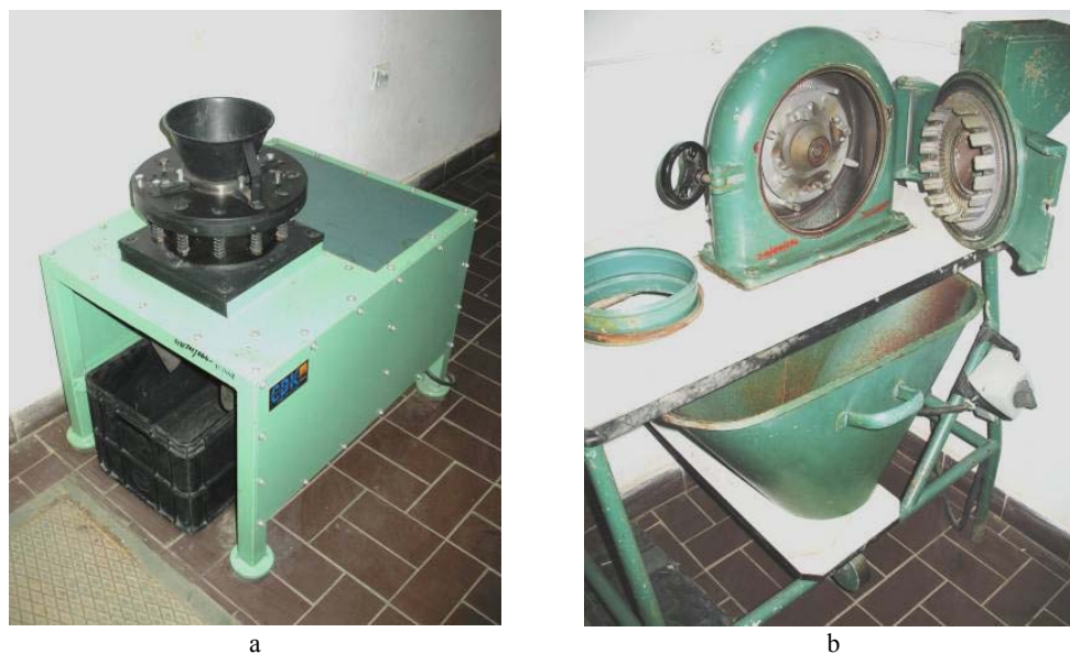
Rys. 3.17. Laboratoryjne kruszarki stożkowe (a) i laboratoryjny dezintegrator palcowy (b)
