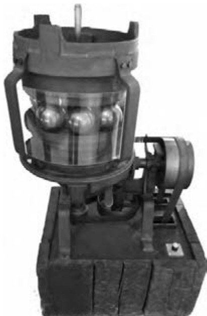
Rys. 2.5. Maszyna Fischera do szlifowania kul
