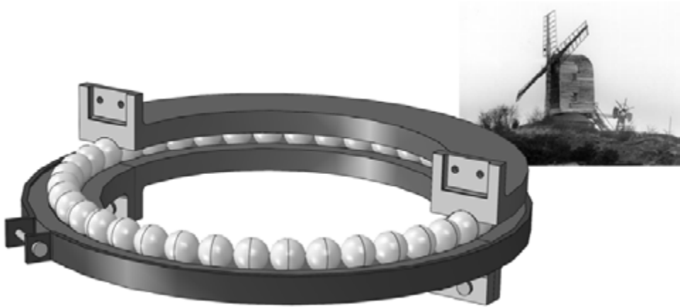
Rys. 2.4. Wiatrak w Sprowston (1780) i model łożyska
