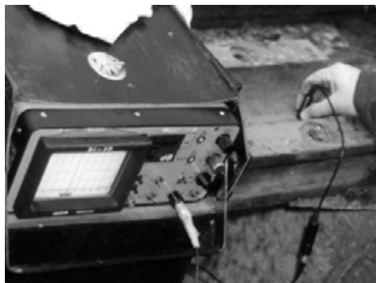
Rys. 11.18. Pomiar bezpośredni grubości bieżni metodą ultradźwiękową
