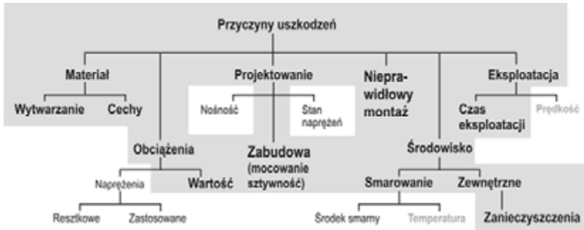
Rys. 11.13. Diagram przyczyn uszkodzeń łożysk tocznych, na polu zacienionym oznaczono główne przyczyny występujące w łożyskach wielkogabarytowych, wg [91]
