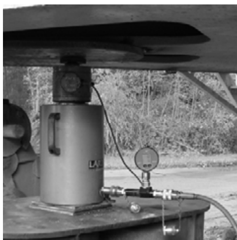
Rys. 12.6. Widok manometru precyzyjnego, dynamometru tensometrycznego oraz manometru precyzyjnego podczas ważenia zwałowarki
