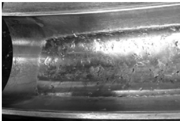
Rys. 11.10. Zdegradowana bieżnia łożyska ładowarko-zwałowarki o bieżni normalizowanej – materiał C45 normalizowany, czas eksploatacji 4 lata, przyczyna: zbyt wiotki podzespół wsporczy
