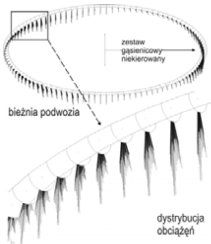
Rys. 5.41. Wektory sił wypadkowych działających na bieżnię dolną (podwozia) łożyska dla różnych położen nadwozia koparki względem podwozia
