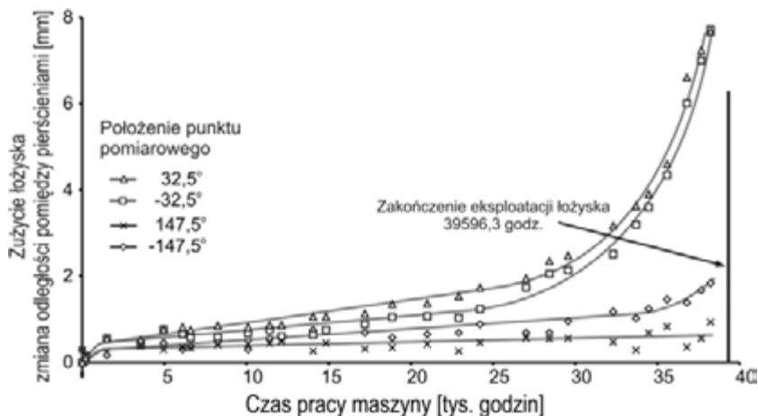
Rys. 11.17. Zużycie odkształceniowe łożyska ładowarko-zwałowarki ŁZKS-1600, pomiary A. Kupskiego [332]
