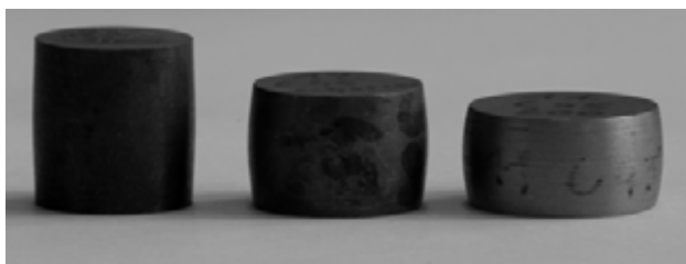
Rys. 6.14. Widok zgniecionych próbek o różnych twardościach po próbie ściskania (stal C45)
