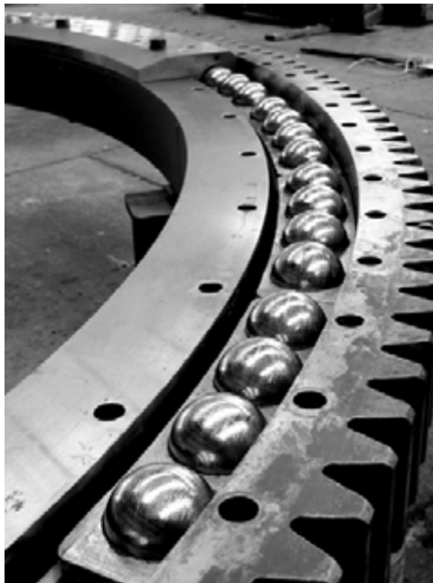
Rys. 2.10. Kule i fragment wieńca zębatego – łożo kulowe ładowarko-zwałowarki
