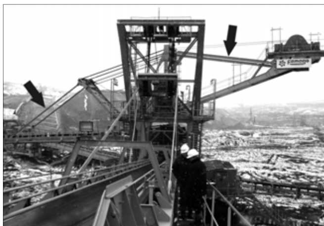
Rys. 12.29. Przenośnik samojezdny – cięgna wymagające identyfikacji napięcia oznaczono strzałkami
