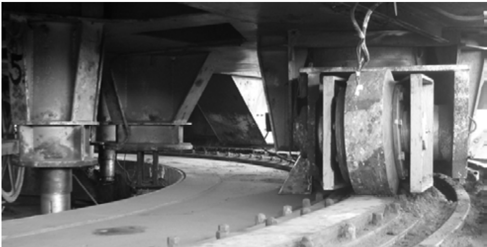
Rys. 2.9. Obrotnica z wózkami jezdными i rolkami centrującymi – koparka KWK-1500
