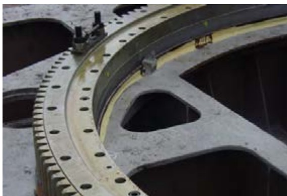
Rys. 10.35. Wylewanie wylewki epoksydowej pod łożysko wieńcowe: przygotowanie powierzchni pod wylewkę – ustawienie kołków (a), wylewanie – masa grawitacyjnie „poziomuje się” (b), położenie łożyska na wylewce (na kołkach montażowych) (c)
