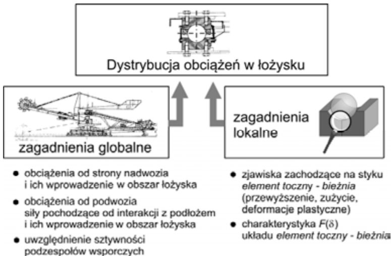
Rys. 5.17. Schemat ideowy analizy dystrybucji obciążeń w łożysku [340]
