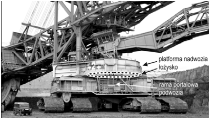
Rys. 7.5. Koparka kołowa SchRs-4600.30 – podwozie i platforma nadwozia
