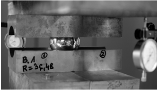
Rys. 11.30. Doświadczalne wyznaczenie charakterystyki układu bieżnia–kula–bieżnia
