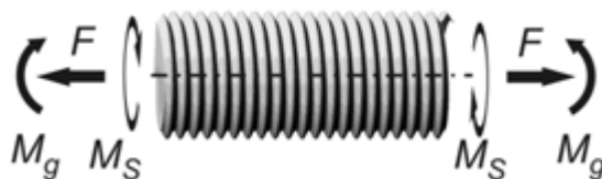
Rys. 5.59. Schemat obciążeń śruby: rozciąganej siłą osiową F , skręcającej momentem M_T i zginanej momentem giętym M_B
