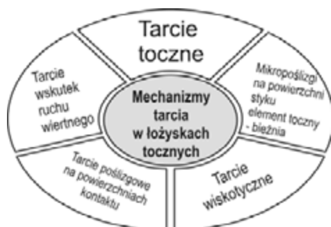
Rys. 11.70. Mechanizmy tarcia w łożysku
