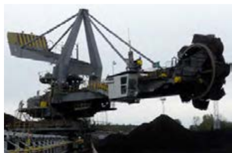
Rys. 8.65. Ładowarko-zwałowarka ŁZKS-1600.33 – widok i schemat kinematyczny
