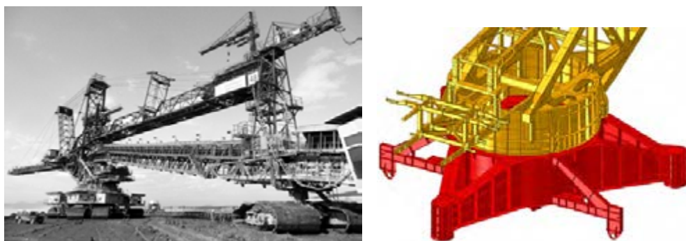
Rys. 8.52. Zwałowarka ZGOT-11500.100 w KWB Turów i model jej węzła obrotu
