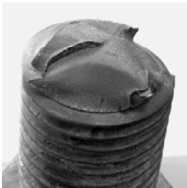
Rys. 5.64. Zniszczona śruba M42 połączenia kołnierzewego
