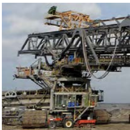
Rys. 8.25. Węzeł podparcia mostu koparki SchRs-4000.37,5 – widok i model geometryczny ze schematem obciążenia
