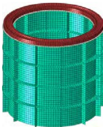
Rys. 9.9. Model dyskretny płaszcza dźwigara pierścieniowego z kołnierzem i uźebrowaniem
