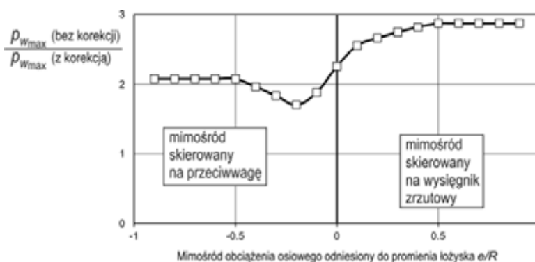
Rys. 10.15. Miara dobroci stosowania korekcji – stosunek maksymalnego obciążenia właściwego z korekcją i bez korekcji
