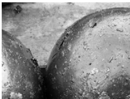
Rys. 11.8. Kule łożyska pokryte złuszczynami
