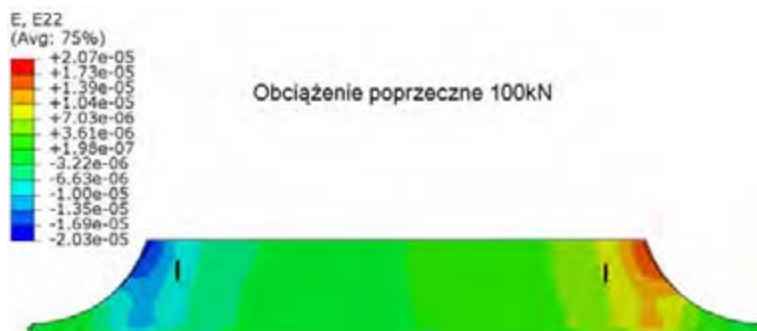
Rys. 12.25. Warstwice odkształceń poprzecznych z zaznaczonymi miejscami naklejenia tensometrów
