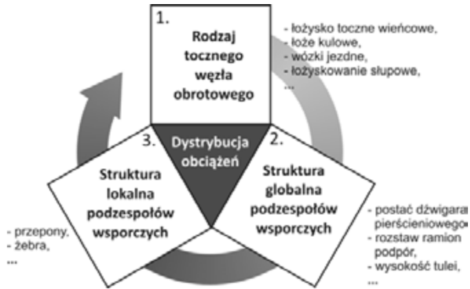
Rys. 9.2. Etapy projektowania węzła obrotowego
