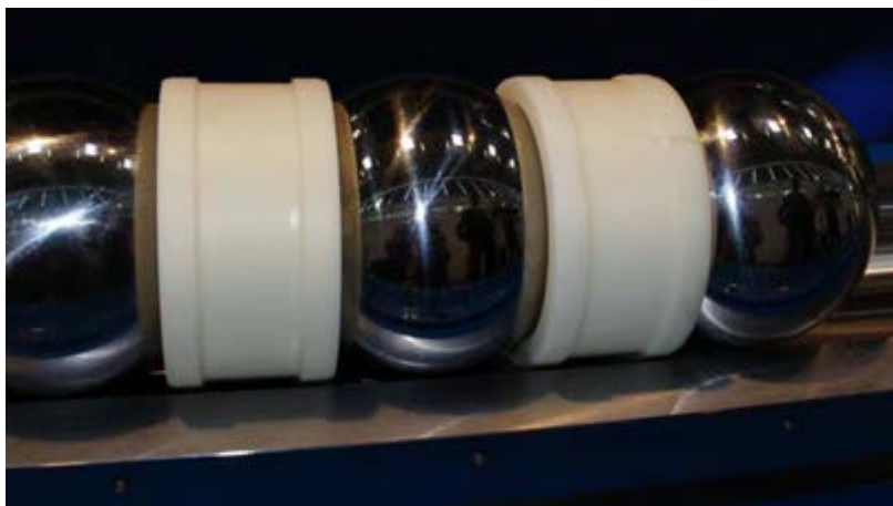
Rys. 3.13. Separatory w łożysku wieńcowym (TAKRAF)
