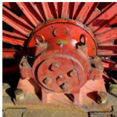
Rys. 7.29. Rozmieszczenie czujników: schemat i zdjęcie
