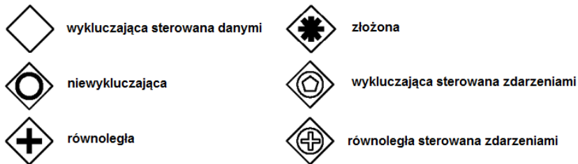
Rys. 2.4: Zestawienie symboli bramek logicznych
