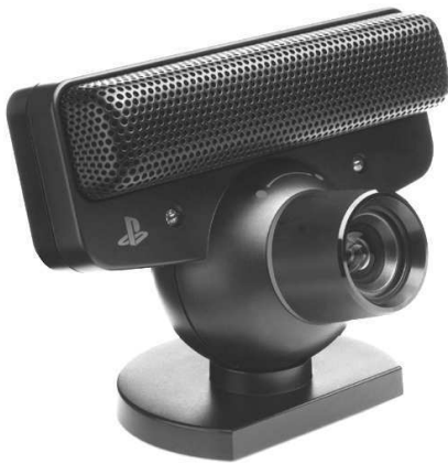
Rys. 6.2: Elementy systemu sterowania odpowiedzialne za pozyskiwanie i generowanie sygnałów wizyjnych SwarmBota : a) kamera Playstation EYE, b) płytkę z rozmieszczonymi na niej diodami identyfikacyjnymi
