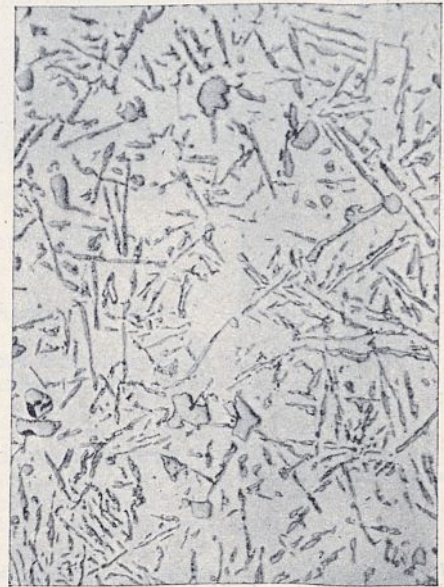
Fig. 4.—13.2 per cent. silicon. Edge of ingot. \times 150 .
