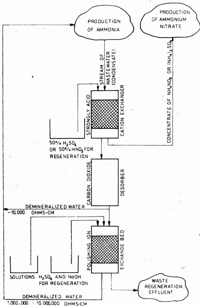
Fig. 5. Recycling of ammonia and water from wastewater of ammonia processing to technological process by ion exchange method. Rys. 5. Jonitowa metoda zawracania amoniaku i wody ze ścieków z produkcji amoniaku do procesu technologicznego.
