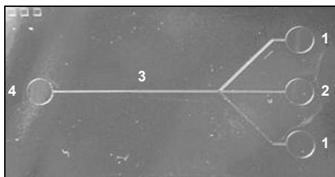
Fig. 8. PDMS microfluidic chip.
