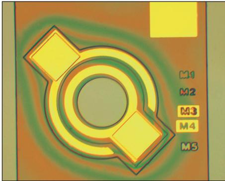
Fig. 3. Photo of the Ga(As,N)/GaAs DQW p-i-n photodetector.
