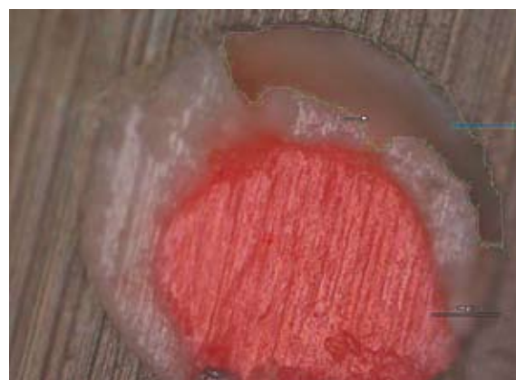
Ryc. 1. Widok mikroskopowy przekroju kanału korzeniowego zresekowanego wierzchołka wypełnionego cementem fosforanowym Hoffman's (pow. 100 \times ). Nieszczelność oznaczona strzałką i otoczona zieloną linią
