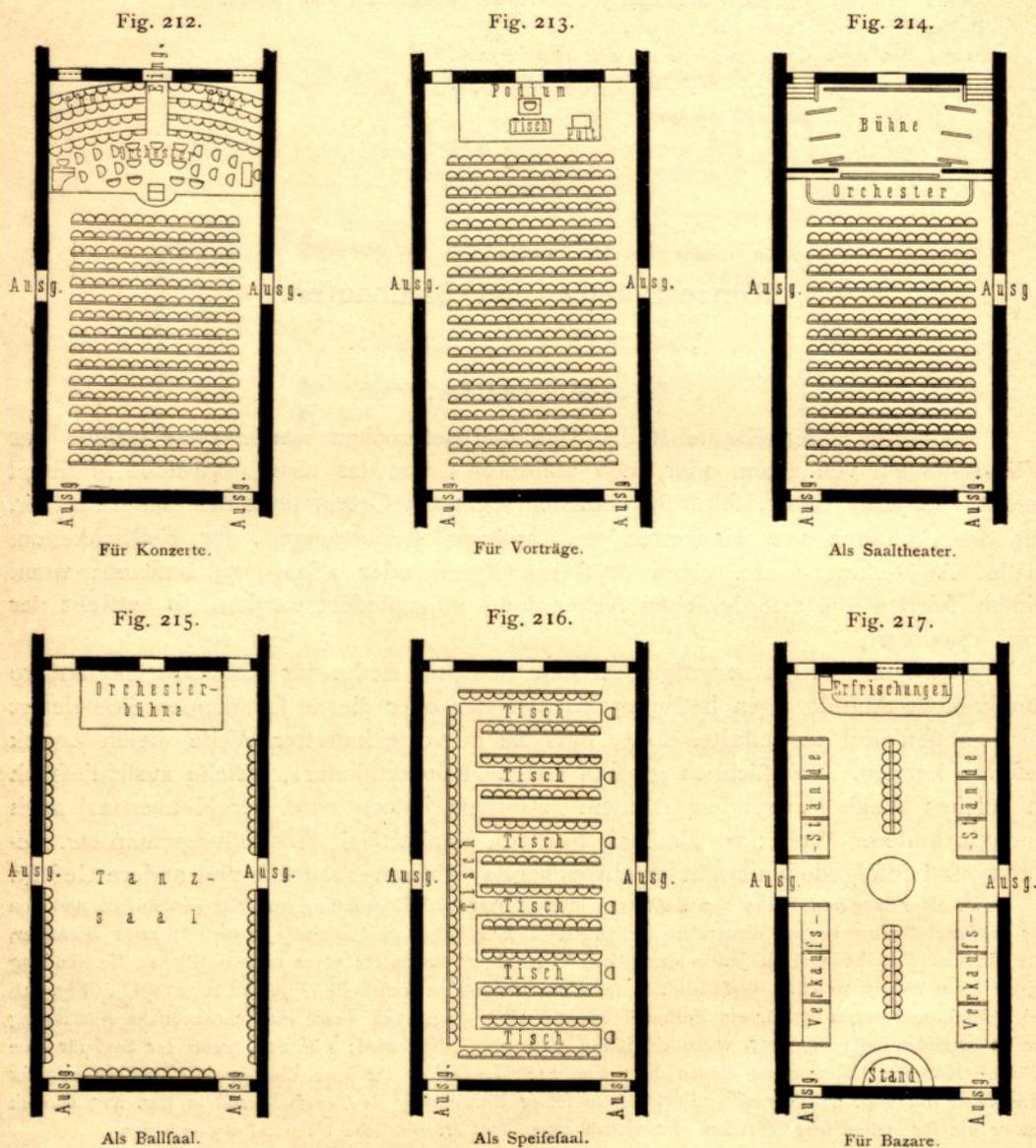
Fig. 212 bis 218: Verwendung des gleichen Saales für verschiedene Zwecke<sup>130)</sup>.
