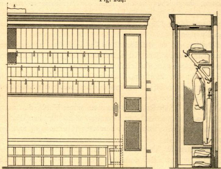
Einrichtung einer Kleiderablage, mit Lüftungseinrichtungen versehen<sup>188)</sup>.ca.  $\frac{1}{50}$  w. Gr.
